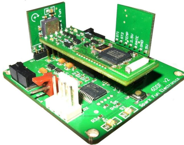
Рис. 3. Плата бортовых сенсоров.
